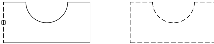
a) Trước khi Join (6 đối tượng) b) Sau khi join (thành 1 đối tượng Pline) Hình 3.32
