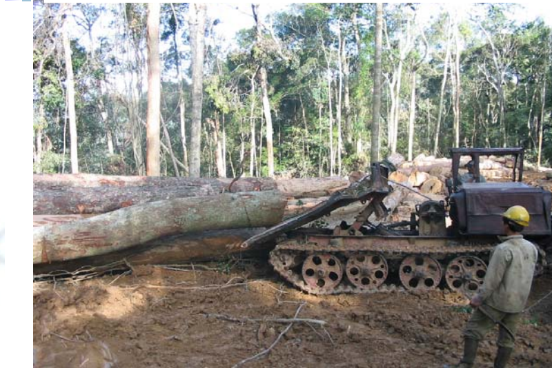
Hình 2. Xếp gỗ tại bãi bằng cơ giới
