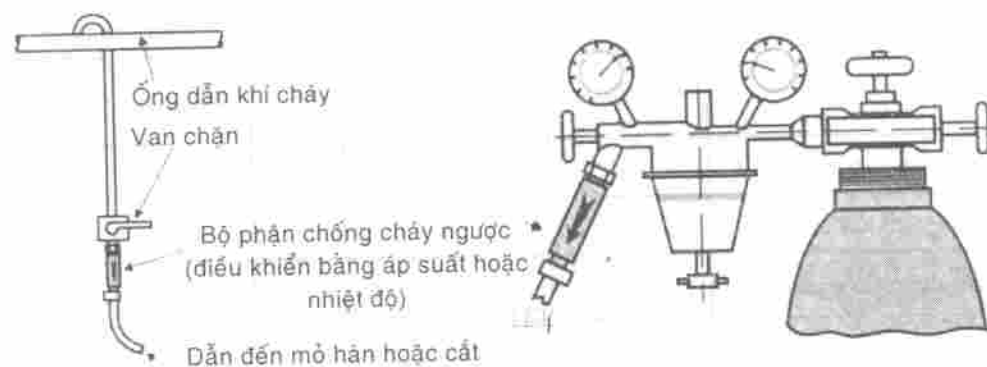
Hình 1-9 Cơ cấu an toàn ở vị trí hút khí
