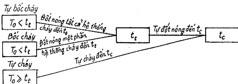
Ta thấy ngoài sự phụ thuộc vào nhiệt độ của các chất cháy  $T_o$  đối với nhiệt độ tự bốc cháy của chúng  $t_t$ , trong quá trình phát sinh cháy của tất cả các hiện tượng đều có quá trình chung là sự tự đốt nóng, bắt đầu từ nhiệt độ tự bốc cháy  $t_t$  và kết thúc bằng nhiệt độ cháy  $t_c$ .
