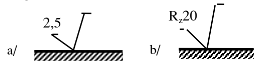
H.1.3. Ký hiệu độ bóng a/ Ký hiệu độ bóng theo R_a b/ Ký hiệu độ bóng theo R_z
