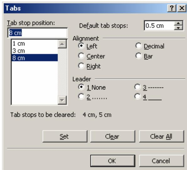
Cuối cùng nhấn nút **Ok** để hoàn tất việc thiết lập tab cho các cột và có thể sử dụng chúng nút **Clear**- để xóa bỏ điểm Tab đang chọn; nút **Clear All** - để xóa bỏ toàn bộ các điểm tab đang thiết lập trên hộp thoại).
