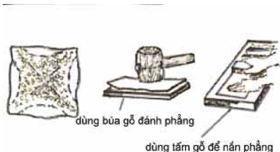
Hình 7- 14 Nắn phẳng vật liệu tấm mỏng
