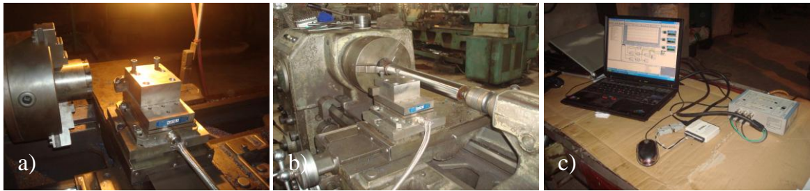
Hình 3.1. Sơ đồ (a,b) và thiết bị thí nghiệm đo lực cắt (c) khi tiện thép hợp kim qua tôi bằng dao PCBN.
