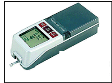
Hình 5.13. Thiết bị đo nhám Mitutoyo SI-201.
