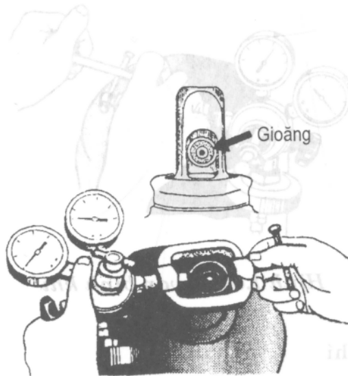
Hình 1.4. Lắp van giảm áp axetylen
