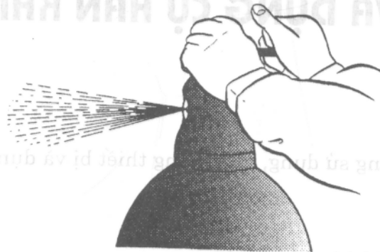
Hình 1.2. Thổi sạch bụi bẩn trước khi lắp van giảm áp
