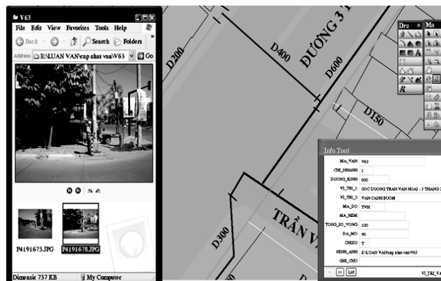
Hình 3. Hình ảnh vị trí van không chế ống cấp nước
